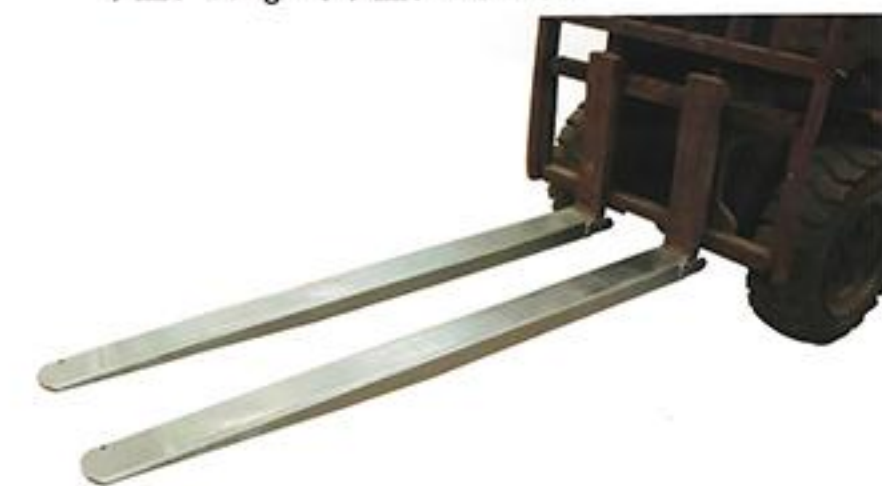
SE-52 叉车加长套(镀锌) Forklift Extensions 长:2000mm 宽:170mm 高:75mm 净重: 69kg 可承重: 1.5T-3T
